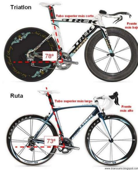
Ilustración 6. Comparación de la bicicleta de triatlón versus la bicicleta de ruta.
