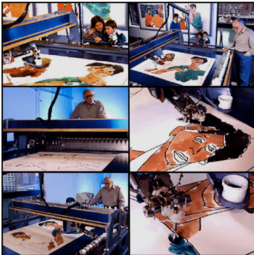
Maquina Aarón , realizando imágenes por impresión de inyección comandada por un ordenador.
