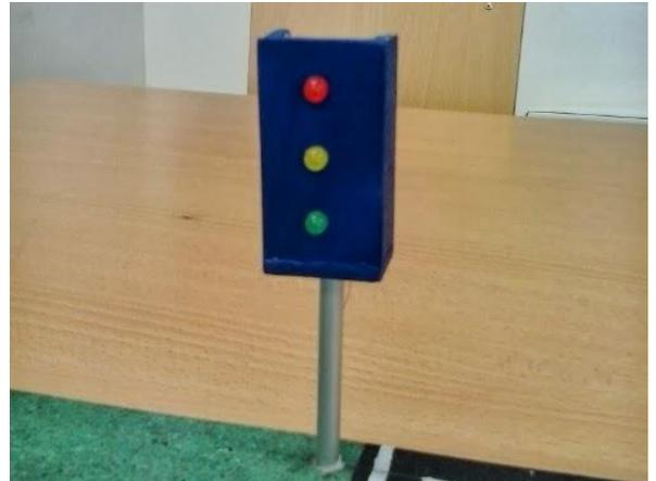
Las luces de los semáforos deben responder a una secuencia de tiempos determinada que se repite periódicamente. En un cruce, mientras un semáforo está en verde, el otro mantiene la luz roja. Para cambiar de color, ambos semáforos pasan a tener luz ámbar durante unos instantes.
