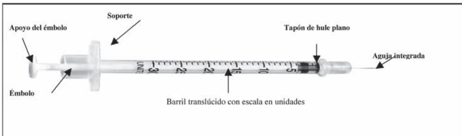
Partes de una jeringa con aguja integrada
