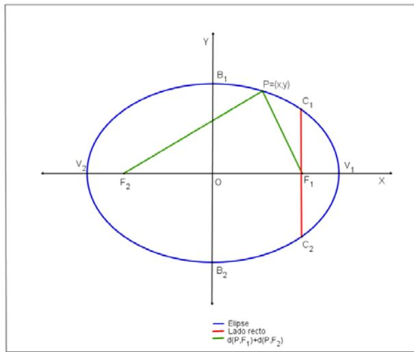
Luego para demostrar la ecuación de la elipse con centro en el origen utilizaremos la siguiente expresión de distancia entre dos puntos del plano. Para esto necesitaremos las coordenadas de los focos y del punto P.
