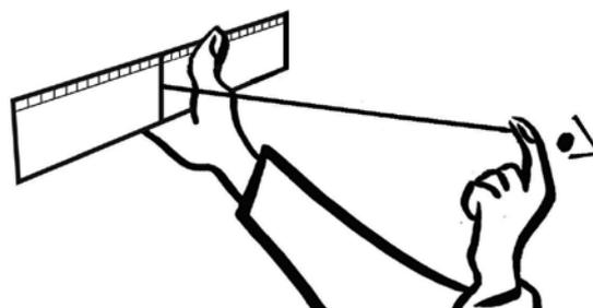
Fig. 2: Usando la herramienta (una regla y un trozo de cuerda de 57 cm de longitud), se pueden medir ángulos con la equivalencia 1cm = 1°.
