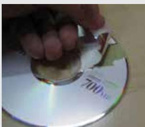
Fig. 10b: Retirando la capa metálica del CD, con cinta adhesiva
