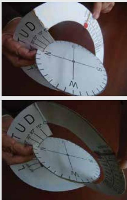
Fig. 11a y 11b: Preparación del simulador para el hemisferio norte con la latitud  $+40^\circ$
