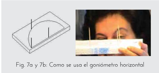
Fig. 7a y 7b: Como se usa el goniómetro horizontal
