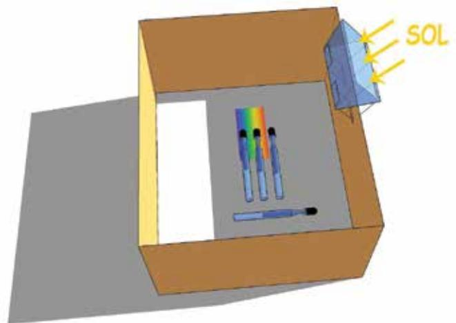
Fig. 15: Dispositivo de Herschel. Los tres termómetros en el espectro marcan mayor temperatura que el ambiente.
