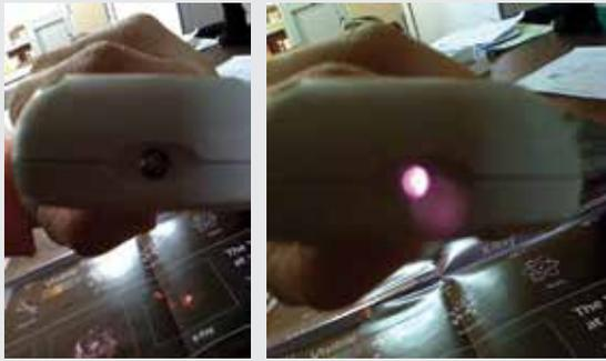
Fig. 17a: Control remoto encendido si lo miramos a simple vista, Fig. 17b: Control remoto si lo miramos a través del teléfono móvil
