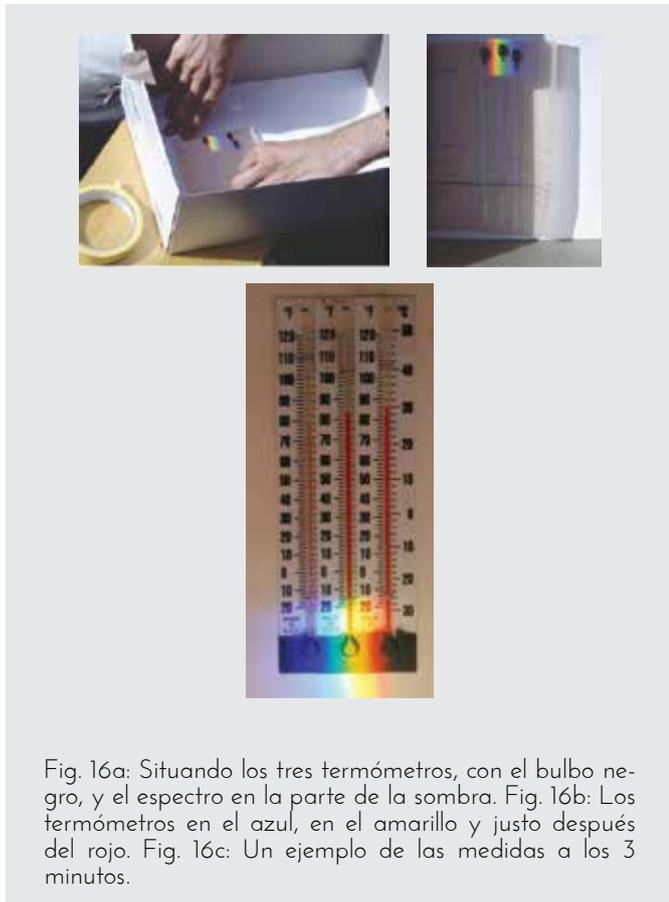
Fig. 16a: Situando los tres termómetros, con el bulbo negro, y el espectro en la parte de la sombra. Fig. 16b: Los termómetros en el azul, en el amarillo y justo después del rojo. Fig. 16c: Un ejemplo de las medidas a los 3 minutos.
