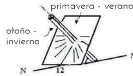
Fig. 20: Reloj ecuatorial en estación (hemisferio norte).
