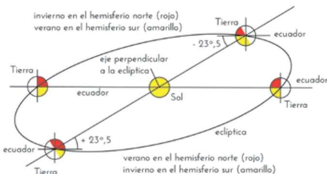
Fig. 1: Esquema del movimiento de traslación. El ángulo entre el plano del ecuador terrestre y el plano de la eclíptica es de  $23,5^\circ$  así como el ángulo entre el eje de rotación terrestre y el eje perpendicular al plano de la eclíptica  $x$  también de  $23,5^\circ$ .
