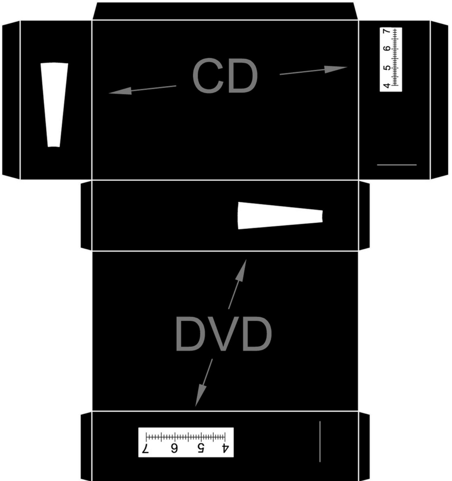
Fig. 12: Plantilla para el espectroscopio
