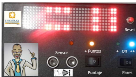
Figura 4. Prototipo dado electrónico de activación por ultrasonido
