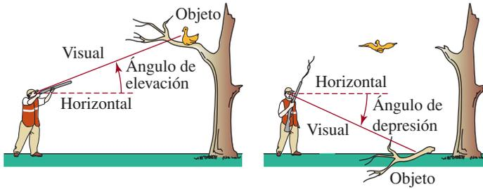
FIGURA 10.2.3 Ángulos de elevación y depresión
