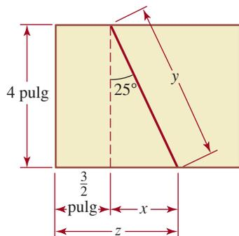
**FIGURA 10.2.2** Corte a sierra del ejemplo 2
