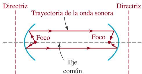
FIGURA 11.1.15 Superficies reflectoras parabólicas del problema 59
