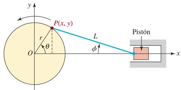
FIGURA 11.5.11 Mecanismo de cigüeñal del problema 35
