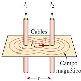
**FIGURA 4.4.7** Cables paralelos para el problema 13
